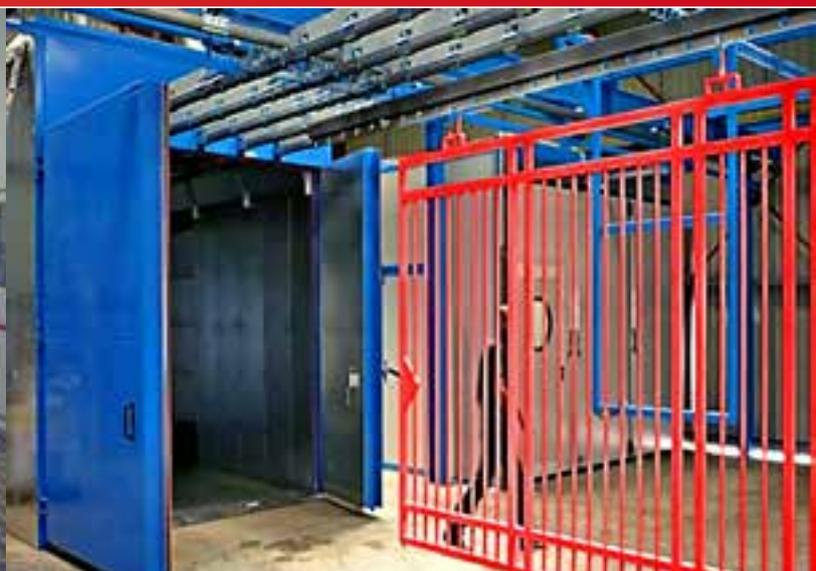
La gamme comprend des cabines de peinture pressurisées avec flux semi-vertical et vertical, avec la possibilité d'une personnalisation totale des dimensions selon les nécessités spécifiques des clients.
