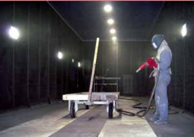
La gamme comprend la récupération partielle ou totale de la grenaille avec un plancher de tôle perforée, de caillebotis ou équipements de sol adaptés pour des charges lourdes. L'intérieur est complètement revêtu de caoutchouc résistant à l'abrasion.
