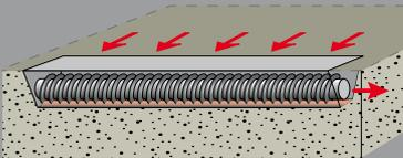
Ce système utilise une vis sans fin pour le transfert de l'abrasif dans la fosse de récupération.
